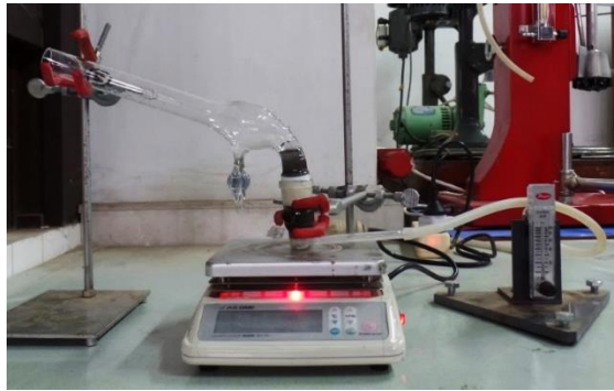
Gambar 3.23 Percobaan mikroflotasi dengan modified Hallimond tube [21]
