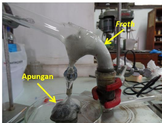
Gambar 3.24 Froth yang terbentuk pada saat mikroflotasi [21]
