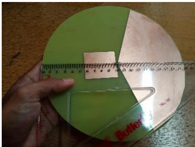
Gambar 58 Bentuk akhir rancangan antenna Tie-Square pada penelitian [51, 52]
