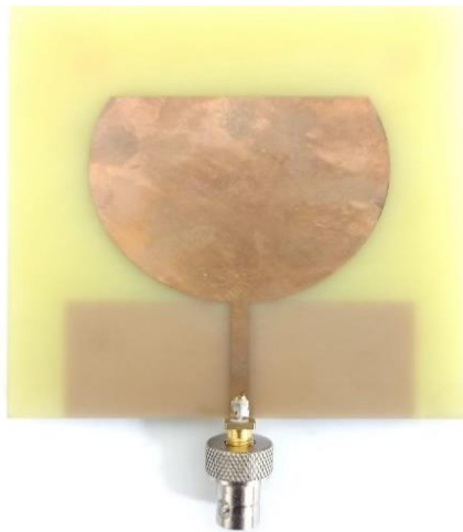
Gambar 59 Bentuk akhir rancangan antenna pada penelitian [53-57]
