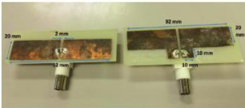
Gambar 45 Bentuk akhir rancangan antenna penelitian antenna dipole (kiri) dan antenna T (kanan) [27, 28]
