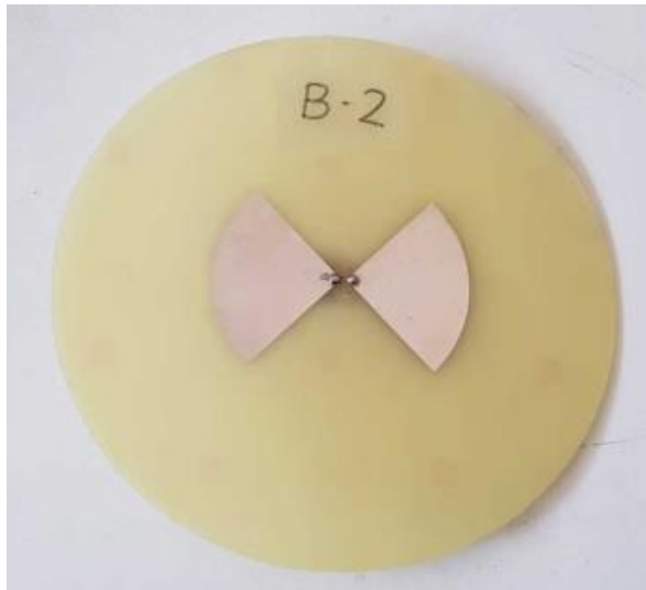
Gambar 56 Bentuk akhir rancangan antenna pada penelitian [49]
