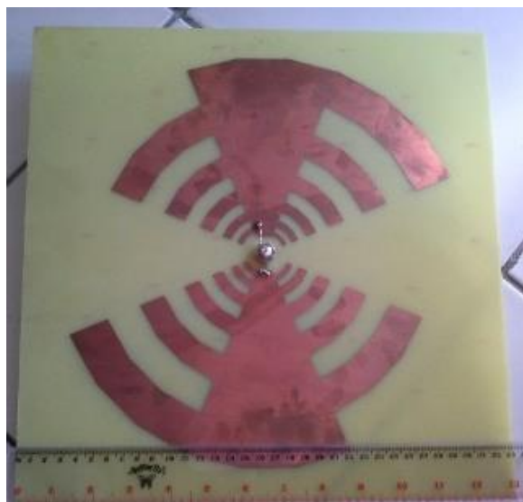
Gambar 49 Bentuk akhir rancangan antenna pada penelitian Log Periodic Toothed 1 [35, 36]
