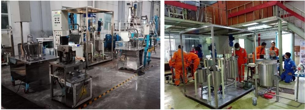
**Gambar 14** Pabrik katalis pendidikan kapasitas 1-5 kg/batch di lab Pilot Teknik Kimia – FTI kampus ITB
