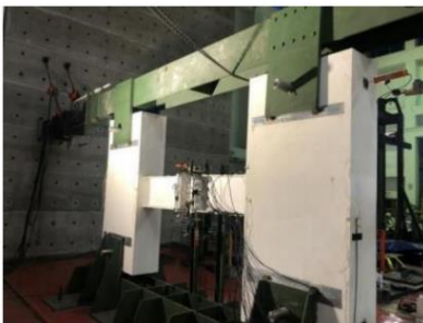
Gambar 44 Pengujian link yang dapat diganti pada struktur core bangunan tinggi [35, 37]
