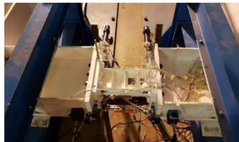
Gambar 44 Pengujian link yang dapat diganti pada struktur core bangunan tinggi [35, 37]
