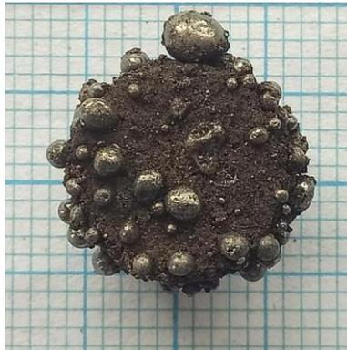
**Gambar 1.12** Logam besi dalam bentuk butiran granul yang keluar di permukaan pelet campuran konsentrat pasir besi dan batubara.
