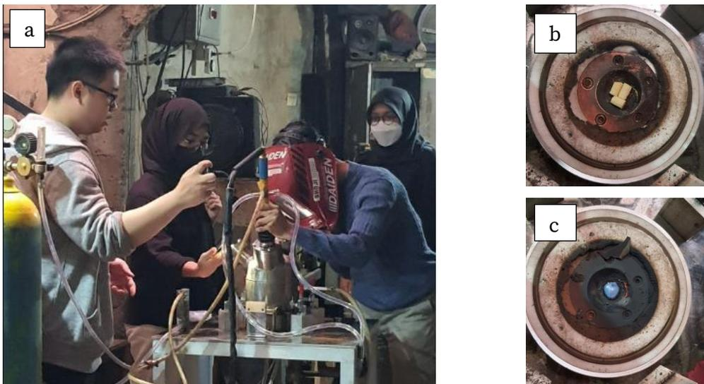
**Gambar 3.1** a. Percobaan pendahuluan di bengkel, b. Biji nikel laterit sebelum dilebur dalam reaktor plasma hidrogen, c. Hasil peleburan dalam waktu kurang dari 5 menit.
