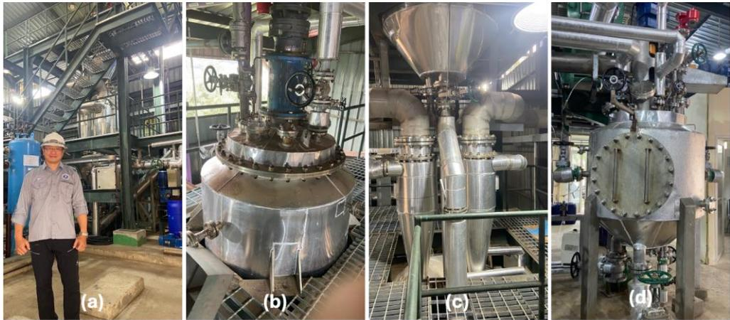
**Gambar 24** Pabrik Pilot Pengolahan TKS: (a) reaktor *pretreatment*; (b) bagian atas dari reaktor *pretreatment*; (c) siklon untuk menangkap semburan TKS olahan dari reaktor *pretreatment*; (d) reaktor hidrolisis enzimatis.
