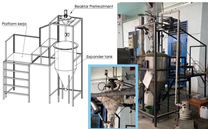
**Gambar 13** Rancangan reaktor *pretreatment* skala 1000 mL berpengaduk beserta tangki penampung (*expander tank*) (kiri); foto rangkaian peralatan yang sudah beroperasi (kanan), dan reaktor *pretreatment* (inset).
