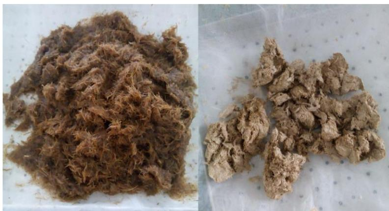
**Gambar 12** Serat TKS sebelum (kiri) dan setelah (kanan) diolah menggunakan larutan NaOH 1 M di dalam reaktor ALFEX (*alkali fiber explosion*) pada kondisi tekanan 5 bar selama 30 menit.
