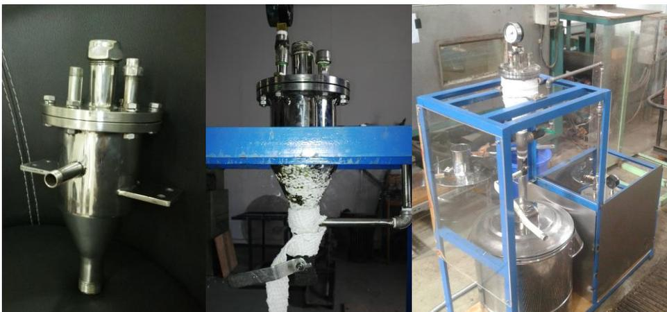
**Gambar 11** Reaktor ALFEX (alkali fiber explosion) berukuran 500 mL dari stainless steel 304 yang dapat beroperasi hingga 10 bar.
