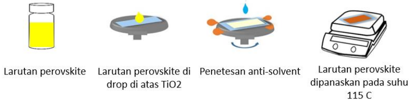
Gambar 46 Proses pembuatan lapisan perovskit dengan teknik spin coating larutan prekursor.
