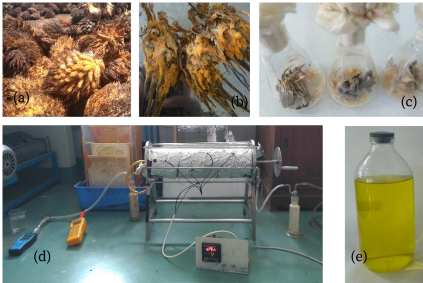
Gambar 33 Fermentasi fasa padat tandan kosong sawit untuk produksi karoten: tandan kosong sawit berjamur jingga (a-b), fermentasi fasa padat dengan Neurospora sp. pada skala lab (c), bioreaktor drum untuk pelaksanaan fermentasi fasa padat (d), ekstrak karoten (e) .
