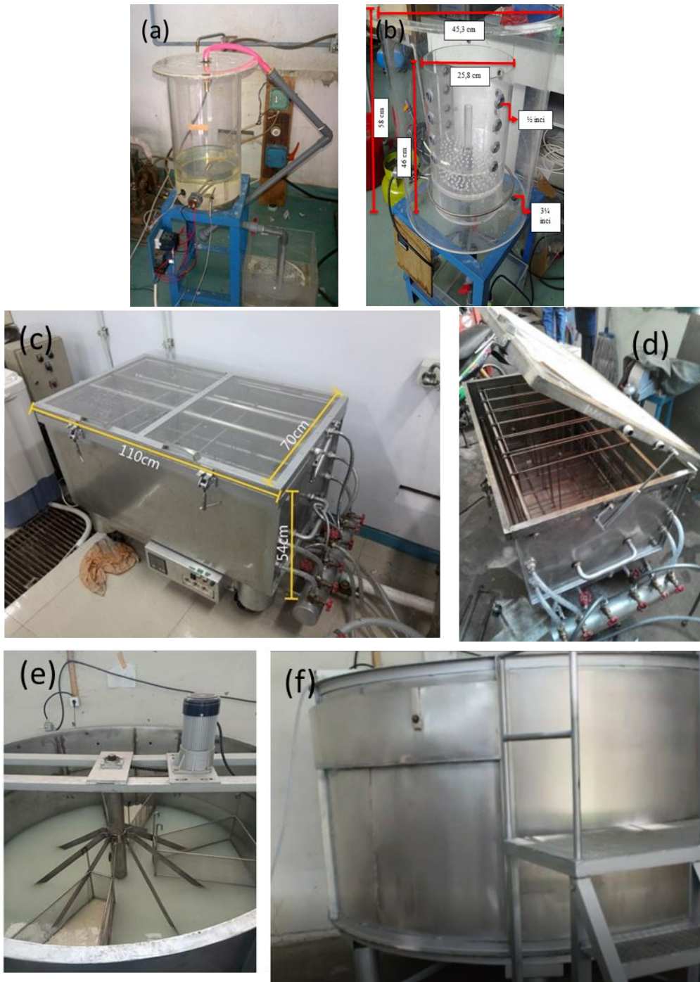
Gambar 12 Contoh desain reaktor untuk fermentasi potongan singkong untuk produksi Fercaf dari skala lab, sampai dengan 3 kg singkong/batch (a - b); skala semi pilot, sampai dengan 1 kuintal/hari (c - d); skala pilot, sampai dengan 1 ton/hari (e - f).
