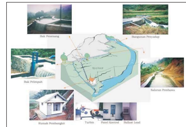
Gambar 22 Sistem Pembangkit Listrik Mikro Hidro [2]
