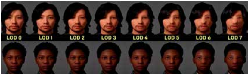
Gambar 5.9 Implementasi pengaturan LOD pada Unreal Engine (Uisco, 2022)
