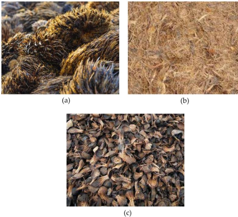
**Gambar 2.10** Tampilan visual tiga jenis biomassa padat dari pengolahan CPO: (a) tandan kosong sawit (b) serat mesokarp (c) cangkang inti sawit.
