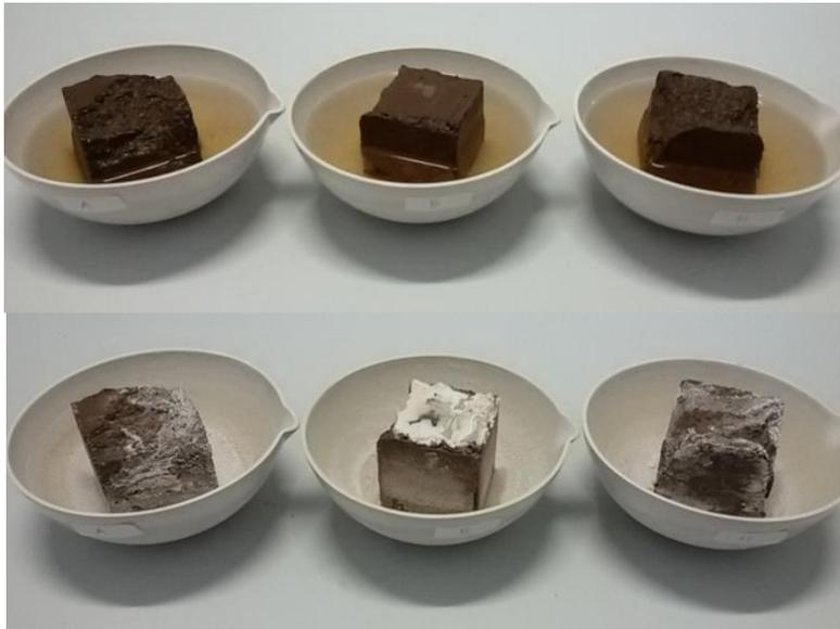
**Gambar 3.6** Peristiwa efluoresensi setelah pemaparan spesimen geopolimer berbasis terak feronikel – abu terbang batubara terhadap atmosfer selama 3 hari (atas) dan 28 hari (bawah).
