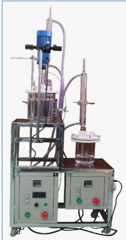
**Gambar 4.5** Unit ekstraktor abu dengan air panas berskala pilot.
