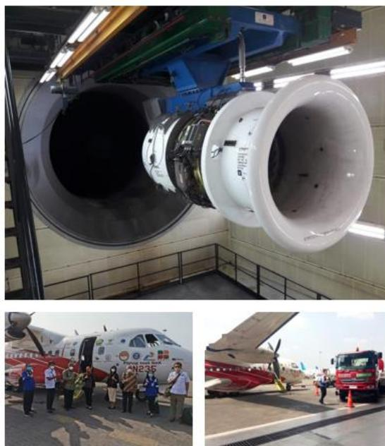
**Gambar 24** Kegiatan uji statik dan uji terbang Bandung-Jakarta dengan CN235 menggunakan avtur biohidrokarbon J2.4.
