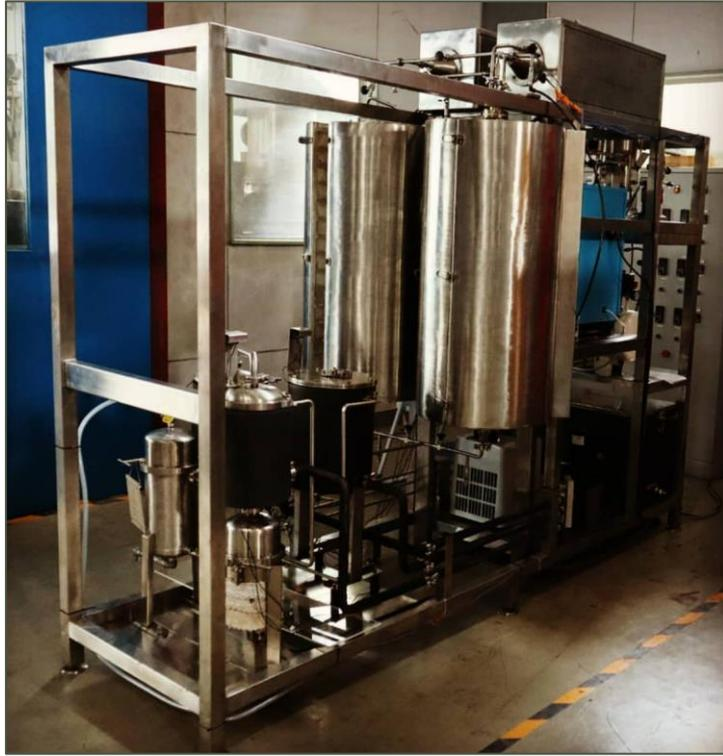
**Gambar 30** Unit reaktor pilot untuk mengkonversi minyak sawit menjadi bensin sawit berkapasitas 20 L bensin sawit/hari.
