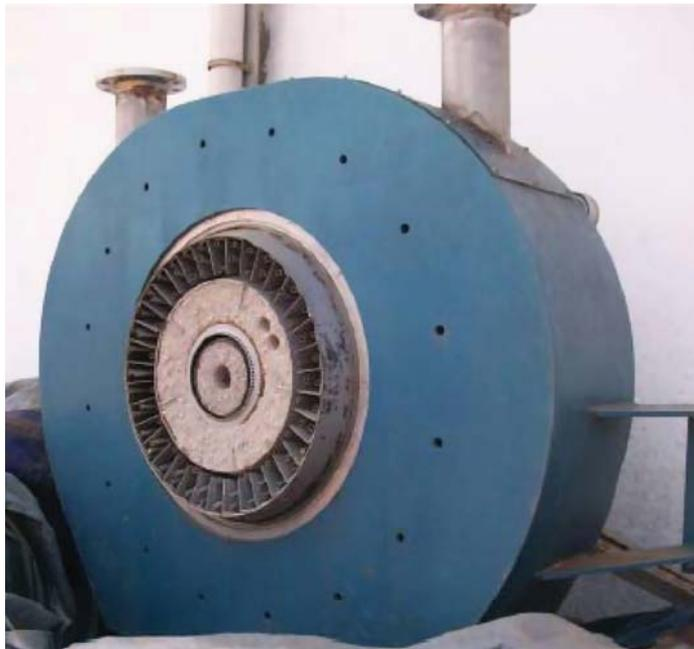
**Gambar 22:** Gas burner yang akan dipasang untuk proses *co-firing* batubara dan gas
