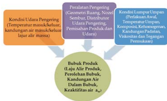
Gambar 3.7 Keterkaitan kinerja pengering sembur dengan kondisi operasi, parameter rancangan dan kondisi umpan
