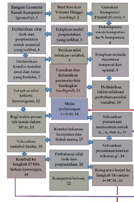
Gambar 4.10 Algoritma Berdasarkan Tekanan Skema SIMPLE atau SIMPLEC untuk Komputasi Paralel
