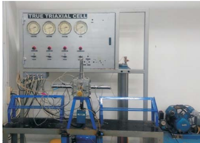
Gambar 14. Alat Truly Triaxial hasil pengembangan Laboratorium Mekanika Tanah - FTSL – ITB
