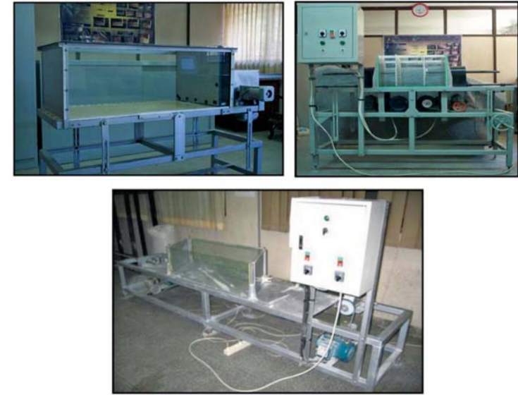
Gambar 7. Tiga jenis apartus pemodelan sandbox yang digunakan untuk pemodelan struktur geologi di Laboratorium Geodinamik ITB.
