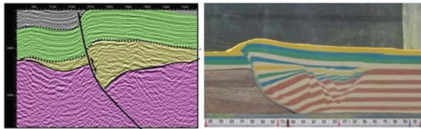
Gambar 16. Pemodelan sandbox sesar inversi (kanan = seismik, kiri = pemodelan sandbox ).
