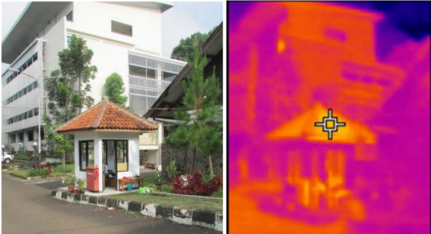
Gambar 6 Citra visible (kiri) dan thermal infrared (kanan). Dinding bata, genteng dan aspal merupakan komponen yang mengemisikan kalor. (Wonorahardjo S., Sutjahja I.M., 2018)
