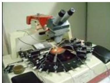
**Gambar 2.18** (a) Prototype GaN/AlGaN HEMT, (b) perbesaran area satu prototype divais, (c) sistem pengujian divais di bawah pembesar, (d) *probe* pengujian
