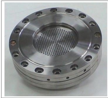
**Gambar 3.12** Gas injector yang sudah dirakit dengan flange bagian atas.
