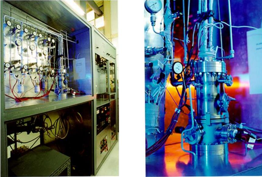
**Gambar 4.1** Sistem MOCVD, (a) *bubbler* dan sistem aliran gas, (b) reaktor MOCVD
