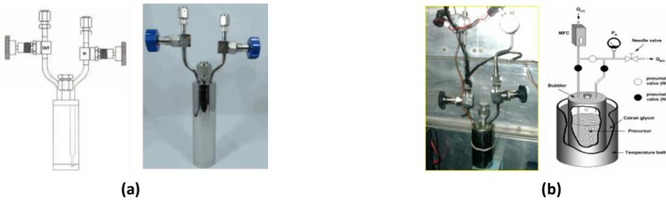
**Gambar 2.5** (a) *Bubbler* terbuat dari bahan *stainless steel* dan dilengkapi dengan keran untuk mengatur aliran. (b) Gas pembawa dialirkan ke dalam *bubbler* agar terjadi penguapan bahan MO. Uap bahan MO selanjutnya dibawa menuju reaktor.
