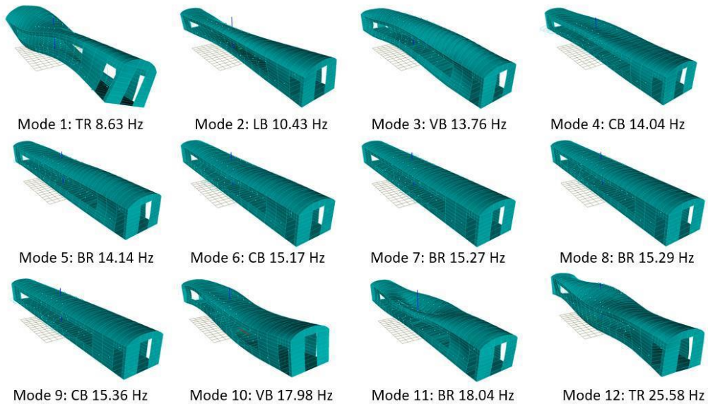
Gambar 5 Modus getar badan kereta dalam bentuk puntir (TR), bending lateral (LB), bending vertikal (VB), breathing (BR), dan kombinasi (CB) dalam rentang 0 -30 Hz (Yaffie, et al., 2023)
