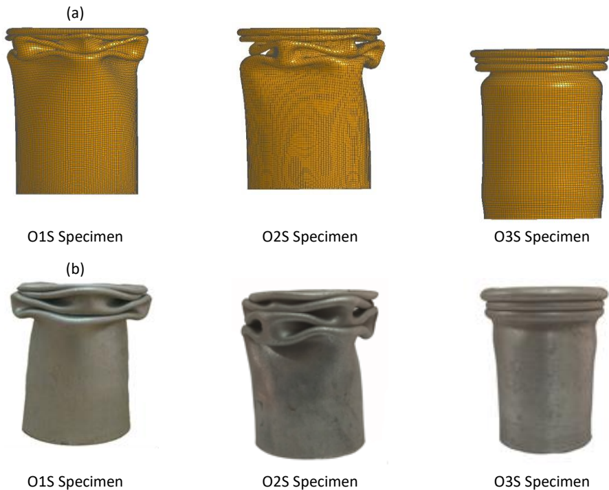
Gambar 33 Deformasi plastis pada open cylindrical tube yang diperoleh secara (a) numerikal dan (b) eksperimen (Kumar, et al., 2018)
