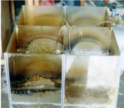
Masing-masing reaktor berisi medium Cair dan biomass serta minyak/sludge Exspan. Reaktor di aerasi dengan Kompresor sebagai sumber udara.
