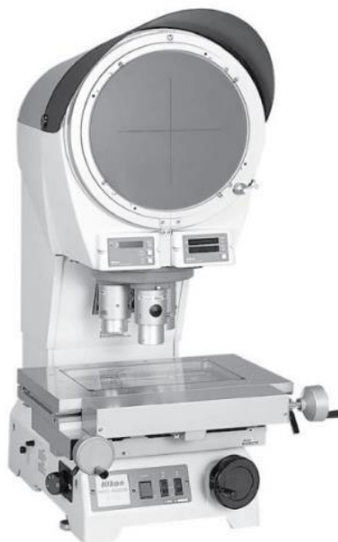
Gambar 4 Nikon Profile Projector dengan akurasi ketelitian pergeseran 3,5 \mu\text{m}
