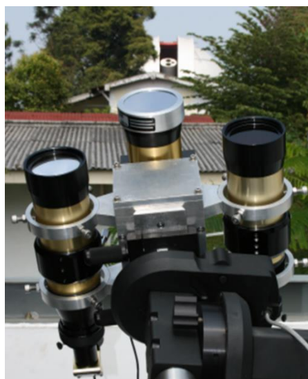
Gambar 12 Teleskop Surya terdiri atas tiga teleskop Matahari mengambil citra secara simultan, yaitu teleskop Ca II (kiri), teleskop visual (tengah), dan teleskop H-alpha (kanan).
