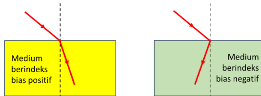
Gambar 3.15 Pembiasan pada medium berindeks bias positif mengikuti aturan Hukum Snell, sedangkan pembiasan pada medium berindeks bias negatif terjadi kebalikan dari Hukum Snell.
