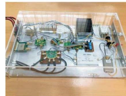
Gambar 2.11 Realisasi radar SFCW kompresif pada frekuensi 700-1400 MHz: (a) Prototip dan (b) Saat beroperasi
