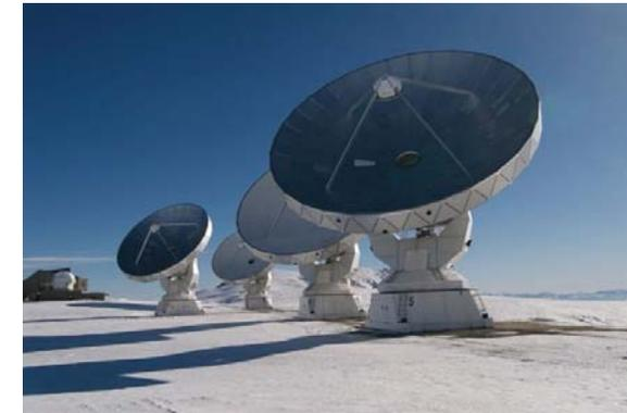
**Gambar 4.** Interferometer radio milimeter IRAM Plateau de Bure yang terletak di Pegunungan Alpen Prancis pada ketinggian 2550 m. Saat ini telah bekerja dengan 7 buah antenna berdiameter 15 m.
