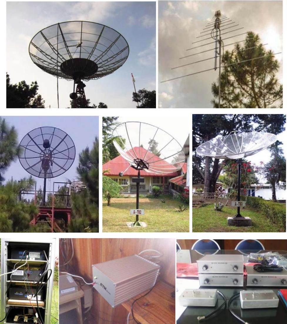
**Gambar 29.** Beberapa teleskop radio ukuran kecil yang dikembangkan di Observatorium Bosscha (terbesar berdiameter 6 m) sebagai bagian persiapan observatorium nasional. Terdapat empat antenna parabolik, tiga array dipol, dan satu antenna LPDA, yang telah diinstalasi beserta receiver dan LNA, termasuk untuk testing sistem interferometri.
