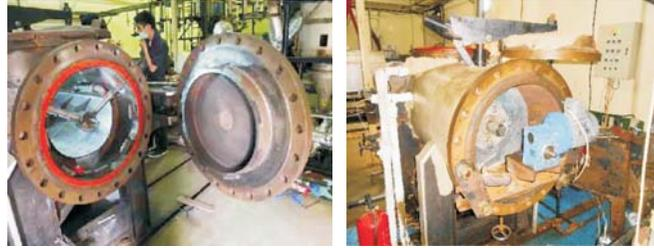
**Gambar 21.** Autoclave untuk proses hidrotermal skala industri
