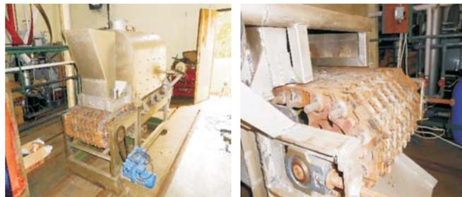
**Gambar 22.** Chain grated incinerator yang dikembangkan
