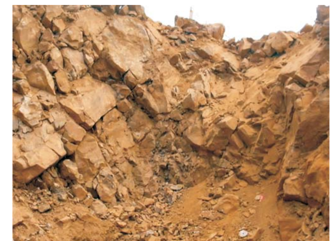
Gambar 3.2. Bidang Diskontinyu Pada Massa Batuan Lereng Tambang, (Sulistianto dkk, 2007a)
