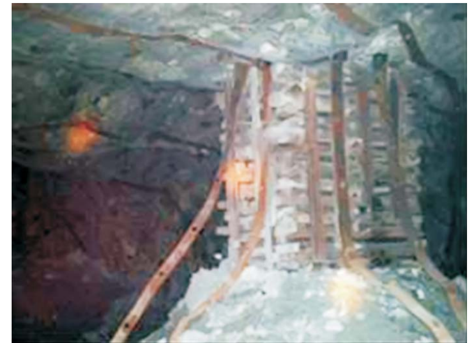
Gambar 4.10 Stope-back yang diperkuat dengan friction bolt , w-strap dan cribbing (Sulistianto, et.al, 2009a)
