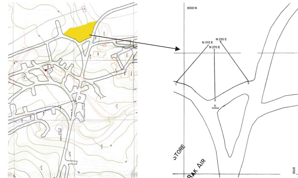
Gambar 4.27 Lokasi dan konfigurasi lubang bor untuk uji hy-frac
