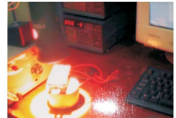
Pengukuran karakteristik output divais sel surya (sumber cahaya: lampu halogen)
