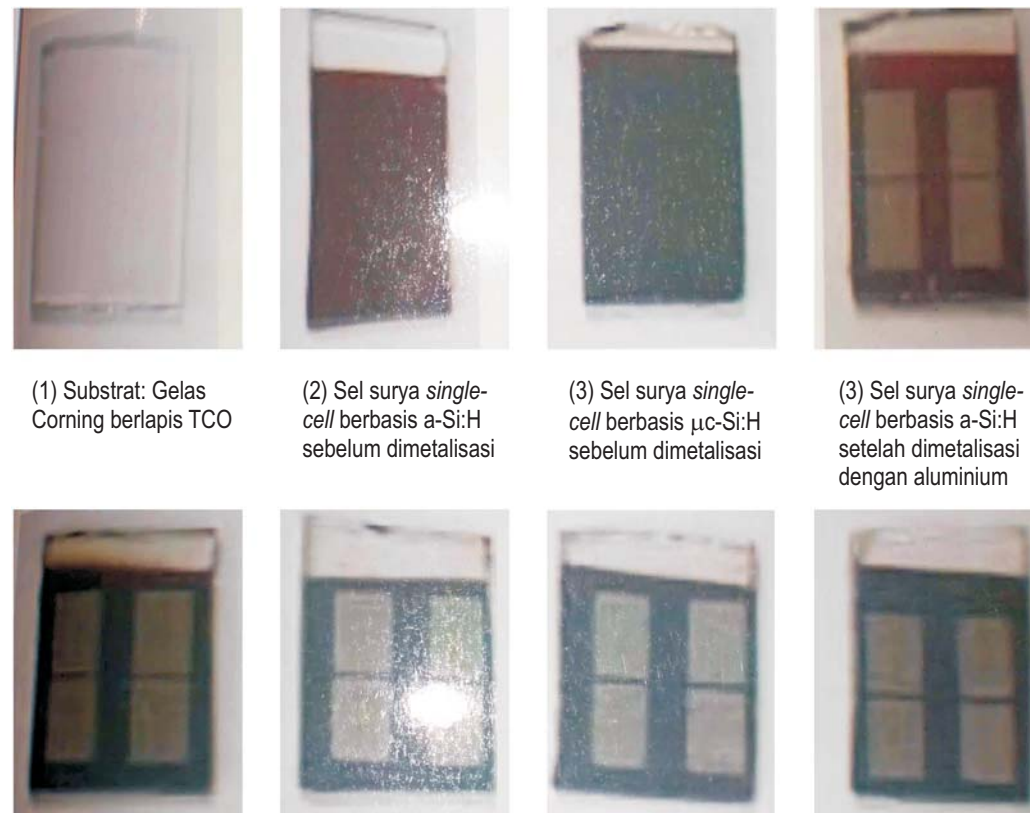
(5) Sel surya tandem-cell berbasis a-Si:H/ \mu\text{c-Si:H} dengan variasi ketebalan lapisan-i pada top-cell setelah dimetalisasi dengan aluminium
