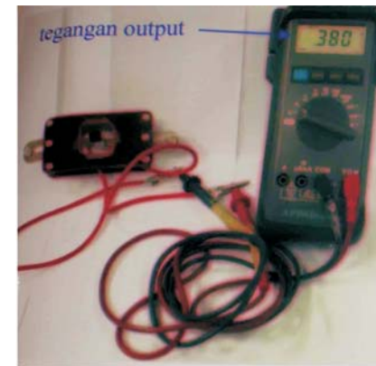
Pengukuran tegangan output divais sel surya (sumber cahaya: lampu ruangan)
