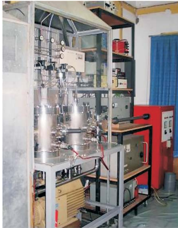
Gambar 3.: Sistem PECVD yang dibangun di Lab PECVD, KK FISMATEL, Prodi Fisika, FMIPA, Institut Teknologi Bandung
