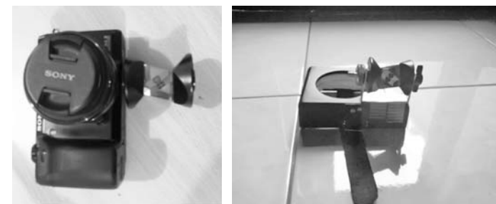
Gambar 2.16 Setting prisma TS Robotic pada kamera
