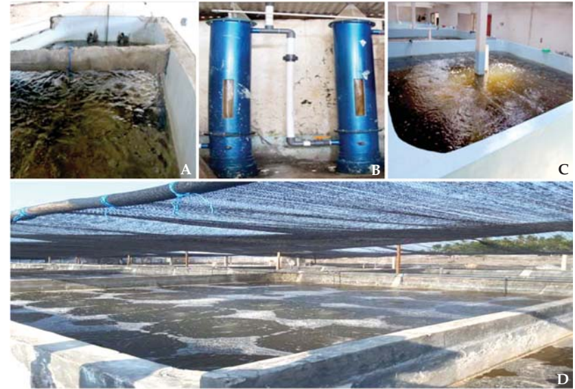
Gambar 12. Komponen sistem Hybrid RAS-ZWD: (A) biofilter, (B) protein skimmer , (C dan D) kolam budidaya udang aplikasi sistem Hybrid RAS-ZWD di Gresik, Jawa Timur, dan Buleleng, Bali (Suantika et al. , 2018)
