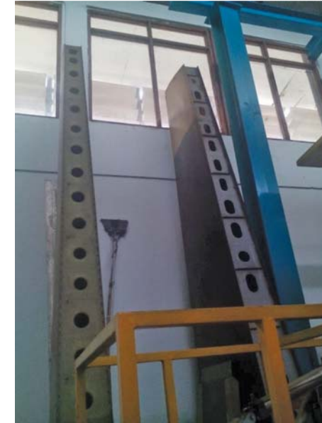
Gambar 8. Vertical stabilizer CN-235 versi komposit (kanan) dan versi aluminium (kiri).
