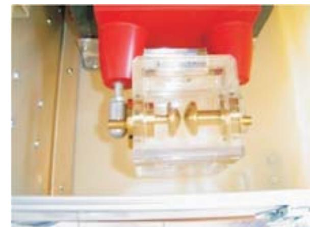
**Gambar 40:** Elektroda untuk penentuan tegangan tembus isolasi cair
