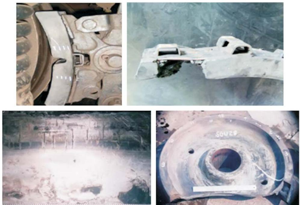
**Gambar 24.:** Mode kegagalan rem blok komposit, permukaan roda yang mengalami heat crack, dan roda pecah karena heat-crack yang merambat. (KNKT 2003).
