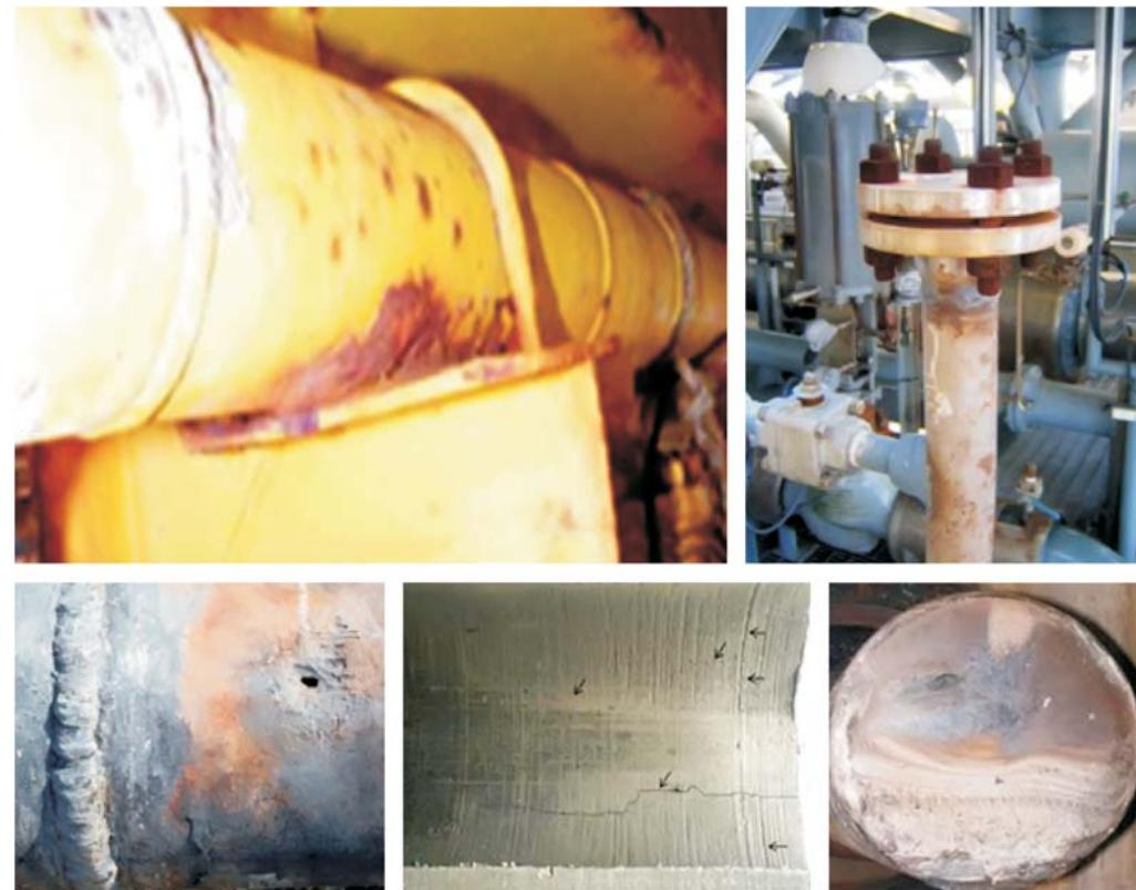
**Gambar 8.**: Contoh bentuk mekanisme kerusakan yg mempengaruhi PoF dengan model *rate* dan *susceptibility*: *crevice corrosion*, *galvanic corrosion*, *pitting corrosion*, *crack* yang merambat, dan *fatigue*, ([www.dnv.us](http://www.dnv.us) dan [www.corrosionlab.com](http://www.corrosionlab.com))
