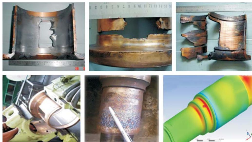
**Gambar 23.:** Mode kegagalan axle lining dan axle kereta api, serta prototype axle lining yang sedang dipasang.
