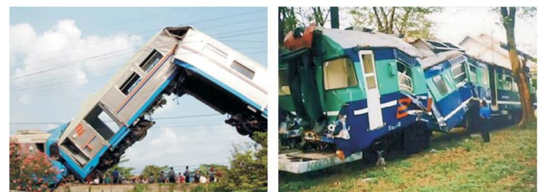
**Gambar 26.:** Kondisi struktur kereta setelah tabrakan yang berisiko langsung terhadap keselamatan penumpang.
