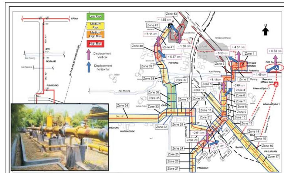
**Gambar 31.**: Kajian Risiko pipa penyalur gas milik PT PGN disekitar lumpur Lapindo, Sidoardjo, dan Offtake porong yang mengalami risiko tinggi.
