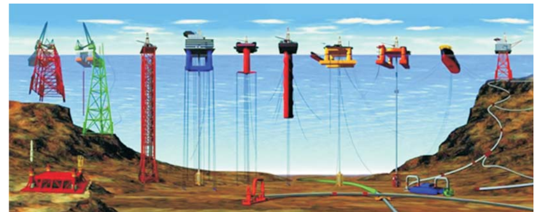
Gambar 2: Perbedaan jenis-jenis struktur lepas pantai. (Courtesy of MMS)
