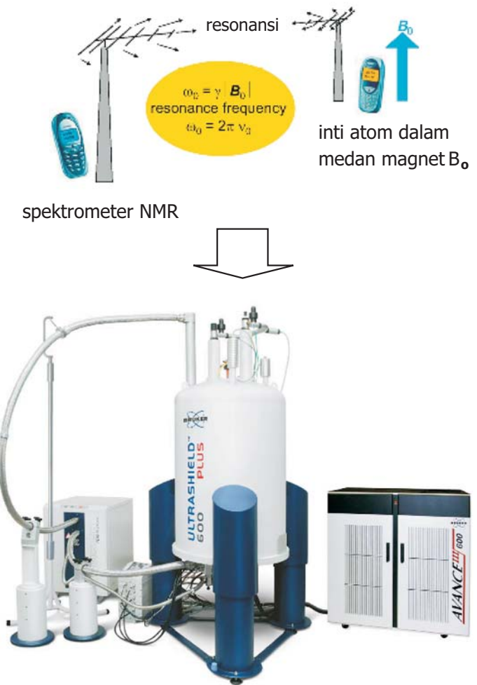
Gambar 4: Peralatan spektrometer NMR, prinsip kerjanya mirip dengan proses komunikasi dua hand phone.
