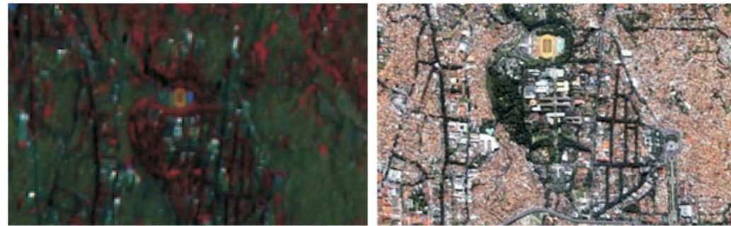
Gambar 2: Contoh kualitas visual citra satelit SPOT5 (kiri) dan citra Quickbird (kanan) (sumber: Pusat Penginderaan Jauh – ITB)
